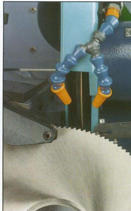
Abschrägen im Naßschliff mit CBN - Schleifscheiben
