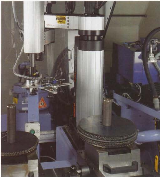
Roh- und Fertigteilmagazin mit jeweils 180 mm Kapazität Industrieroboter für das Sägeblatt-Handling
